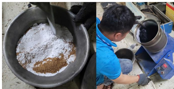
Hình 11. Quá trình chế tạo SMA sử dụng xỉ thép và sợi xơ dừa.
