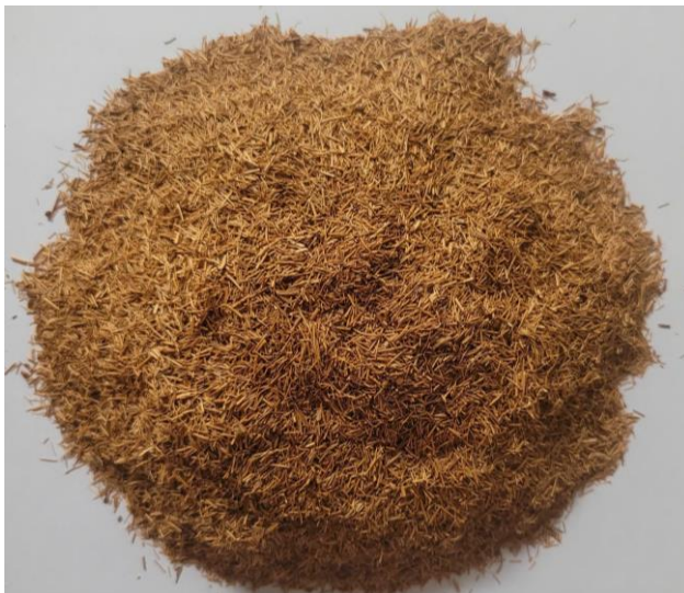
Hình 3. Sợi xơ dừa cắt ngắn (3 – 5 mm).
